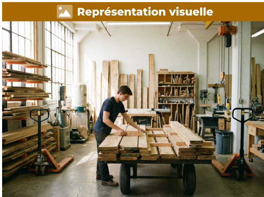
Rangement de planches avec cales tous les 1 m pour éviter les déformations, méthode efficace de stockage
